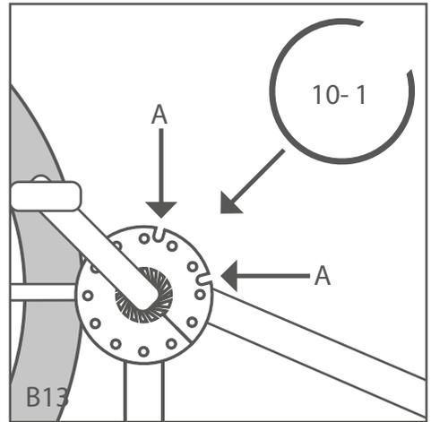
Stecke hierzu die beiden Teile der Magnetscheibe 10 im Freiraum zwischen Tretkurbel und Tretlager so zusammen, dass die Seite mit „Working Surface“ beschriftet in Richtung Fahrradrahmen zeigt. Schiebe die Magnetscheibe 10 gegen den Fahrradrahmen, um sie zu begradigen. [B13] Setze den Haltering 10-1 über die Magnetscheibe 10, um sie zu fixieren. Verdecke hierbei nicht die Einkerbungen [B13 - A] an der Magnetscheibe 10.
