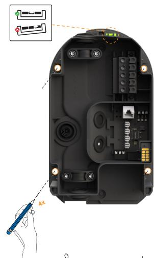
Utiliza el nivel de burbuja integrado y las marcas de la línea central para alinear.
