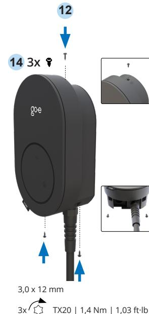
Fija la estación de carga con 3 tornillos TX20 de 12 mm de longitud y un destornillador Torx **con un par de apriete de 1,4 Nm ± 0,1 Nm.**
