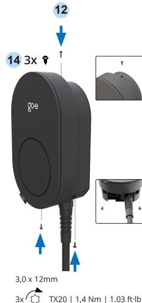
Fixa a estação de carga com 3 parafusos TX20 com 12 mm de comprimento e uma chave de fendas Torx **com um binário de 1,4 Nm ± 0,1 Nm**.
