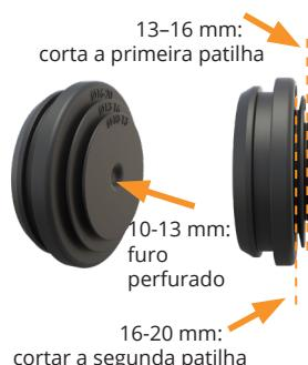
Corta (com um x-ato) ou perfura (por exemplo, com um lápis) o vedante no local indicado para obteres um orifício com o diâmetro do cabo necessário. **As opções de corte recomendadas são apresentadas no lado esquerdo.**
