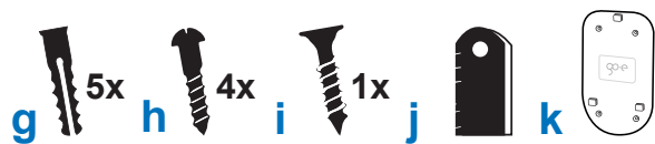
g pluggen 8 x 40 mm h schroeven voor wandhouder 4,5 x 50 mm i Schroef voor U-stuk 4 x 50 mm j U-stuk (optionele diefstalbeveiliging) k wandmontageplaat
