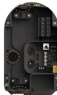
Estrai la guarnizione in gomma preassemblata nel punto di ingresso del cavo di alimentazione prescelto: in alto, sul retro **oppure** in basso. **Le opzioni consigliate per l'alimentazione sono elencate più avanti.**
