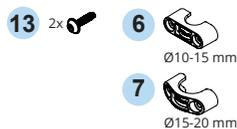
Avvita il morsetto con 2 viti TX20, lunghezza 15 mm e un cacciavite Torx per lo scarico della trazione. **Serrare con 2,7Nm (±0,1Nm).**
