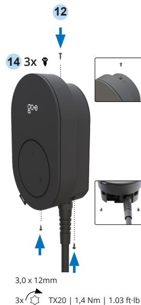
Fissare la stazione di ricarica con 3 viti TX20, lunghezza 12-mm, e un cacciavite Torx, usando una **coppia di 1,4Nm ± 0,1Nm**.
