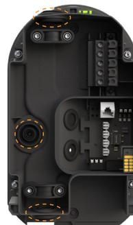
Retire le joint en caoutchouc prémonté au point d'entrée choisi du câble d'alimentation : En haut, à l'arrière **ou** en bas. **Les options d'alimentation recommandées sont indiquées plus loin.**
