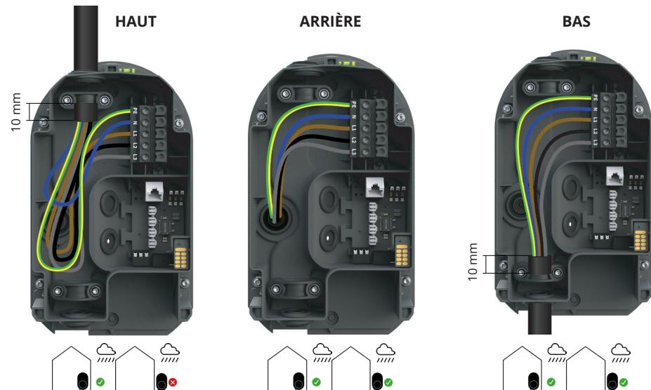
Raccordement de ligne pour réseaux 1 et 3 phases :
