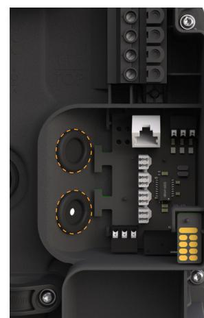
Retire le petit joint en caoutchouc au point d'entrée de câble sélectionné : en haut ou en bas.
