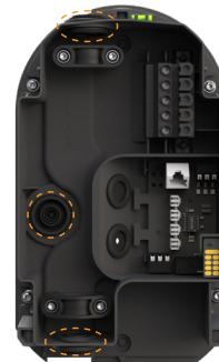
Retire le joint en caoutchouc prémonté au point d'entrée choisi du câble d'alimentation : En haut, à l'arrière **ou** en bas. **Les options d'alimentation recommandées sont indiquées plus loin.**
