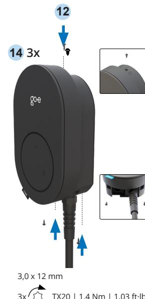
Fixe la borne de recharge à l'aide de 3 vis TX20 de 12 mm de long, de vis et d'un tournevis Torx **à un couple de 1,4 Nm ± 0,1 Nm**.
