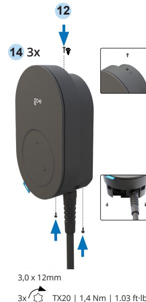
Befestige die Ladestation mit 3x TX20, Länge 12-mm, Schrauben und einem Torx-Schraubendreher **mit einem Drehmoment von 1,4Nm ± 0,1Nm**.
