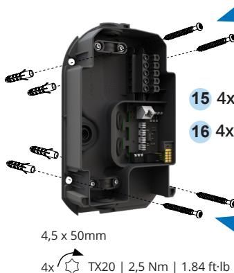
Stecke die 4 Dübel so ein, dass sie bündig mit der Wand abschließen.
