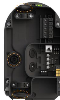
Ziehe die vormontierte Gummidichtung an der gewählten Einführungsstelle des Stromkabels heraus: Also oben, hinten **oder** unten. **Die empfohlenen Optionen für die Zuführung sind später aufgeführt.**
