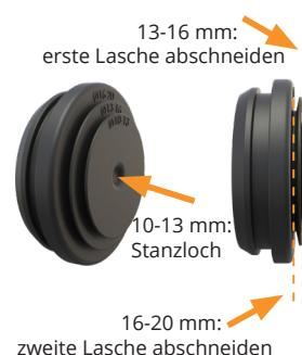
Schneide (mit einem Cuttermesser) oder stanze (z. B. mit einem Stift) die Dichtung an der angegebenen Stelle aus, um ein Loch mit dem erforderlichen Kabeldurchmesser zu erhalten. **Die empfohlenen Schneideoptionen sind auf der linken Seite dargestellt.**
