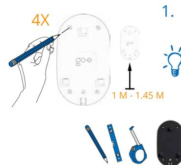
1. Montiere den go-e Charger abhängig vom persönlichen Wohlempfinden ca. 1,00 bis 1,45 Meter über dem Boden.
