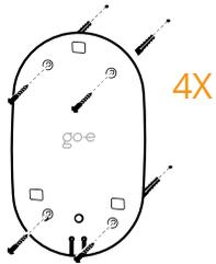
Stelle sicher, dass der Untergrund keine Verwerfungen aufweist. Bei einem Verziehen der Wandhalterung lässt sich das Gerät möglicherweise nicht mehr aufstecken. Eventuelle Unebenheiten der Wand mit Distanzscheiben (nicht im Lieferumfang enthalten) ausgleichen.
