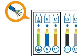
6. Der go-e Charger Gemini (2.0) darf ein- und dreiphasig angeschlossen werden. Falls erforderlich, zusätzliche Versorgungsleitung verlegen. Bei Auslegung des Kabelquerschnitts Gleichzeitigkeitsfaktor und Verlegeart beachten. Wir empfehlen folgende Kabelquerschnitte, jedoch muss die Elektrofachkraft entsprechend lokaler Bedingungen entscheiden:
