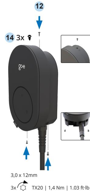
Befestige die Ladestation mit 3x TX20, Länge 12-mm, Schrauben und einem Torx-Schraubendreher **mit einem Drehmoment von 1,4Nm ± 0,1Nm**.
