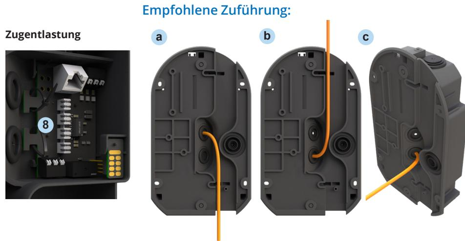
Bei Verwendung des oberen Kabelkanals muss das Datenkabel zunächst wie oben abgebildet um den Zapfen herumgeführt werden, um sicherzustellen, dass Regen von den Dichtungen ferngehalten wird, und um das Risiko des Eindringens zu minimieren.
